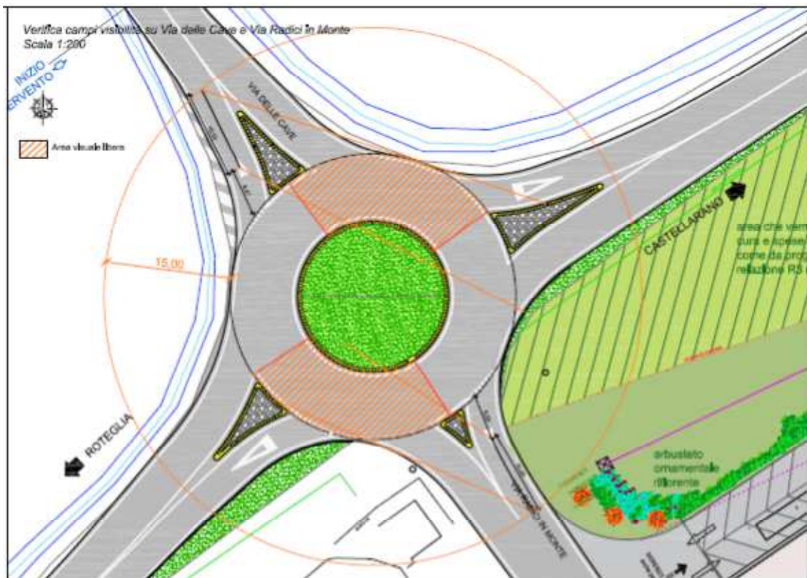
Fig. Verifica campi visibilità su Via delle Cave e via Radici in Monte
