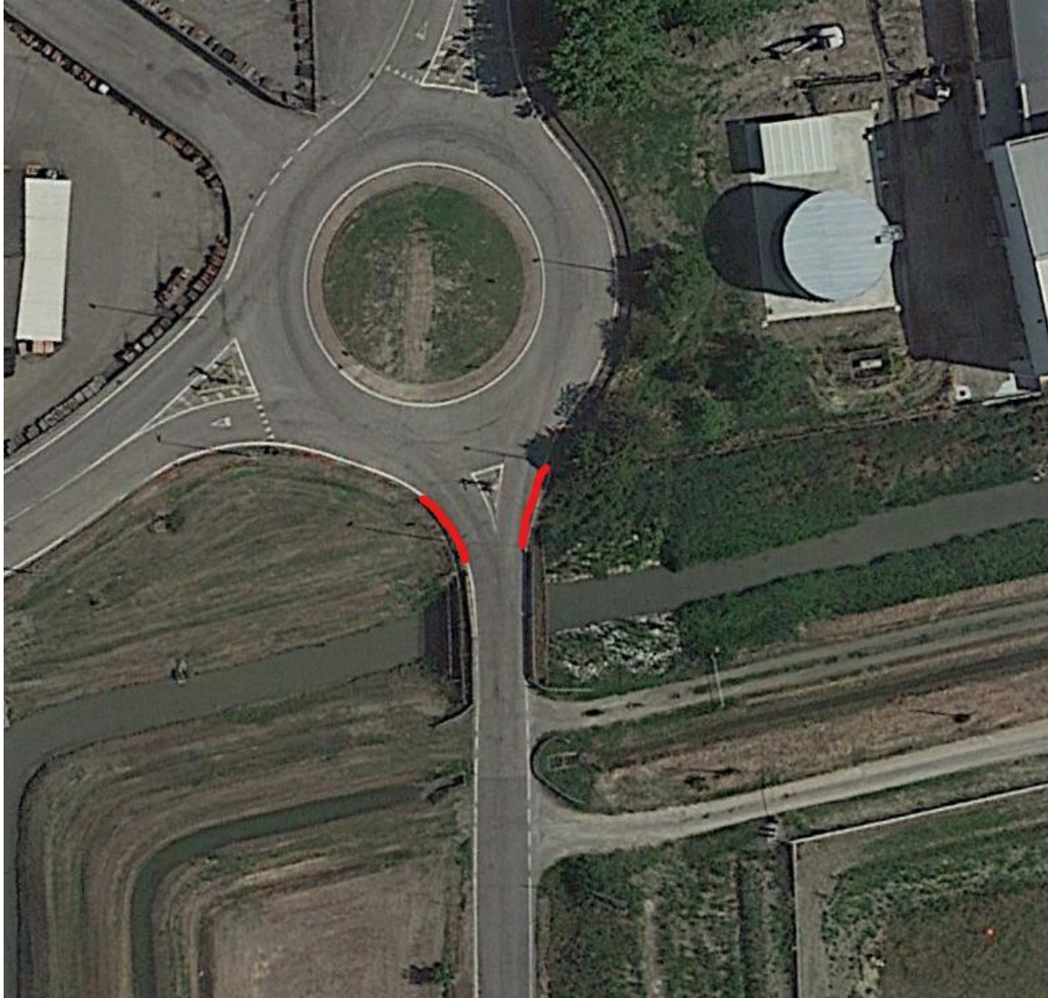
Figura 3.3: Prolungamento barriere laterali.
