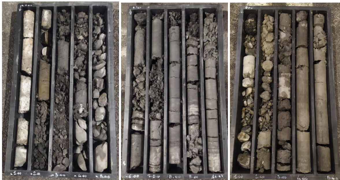
Figura 4.1 Foto carote dei sondaggi a circa pk 175 m (dall'imbocco Sud). Sondaggio S1 eseguito sul rene di monte, tratto da 0 a 5 m (foto di sinistra); sondaggio S2 eseguito sul rene di valle, tratto da 5 a 10 m (foto al centro), sondaggio S3 eseguito verticalmente sul piano viario, tratto da 0 a 5 m (foto di destra). In tutti i sondaggi è ben evidente la scadente qualità dell'ammasso roccioso presente a tergo del rivestimento definitivo.
