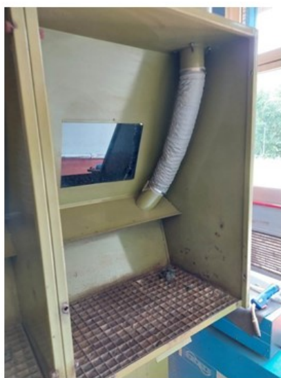
BANCO DI SALDATURA CON ASPIRAZIONE A FESSURA POSTAZIONI DA N° 1 A N° 4
