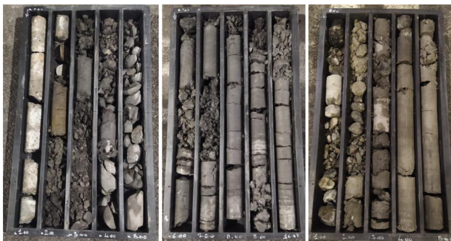
Foto esemplificative dei sondaggi eseguiti: sx) S1 eseguito sul rene di monte, tratto da 0 a 5 m; centro) S2 eseguito sul rene di valle, tratto da 5 a 10 m; dx) S3 eseguito verticalmente sul piano viario, tratto da 0 a 5 m. Si apprezza un'ubiquitaria qualità scadente dell'ammasso roccioso a tergo del rivestimento definitivo.
