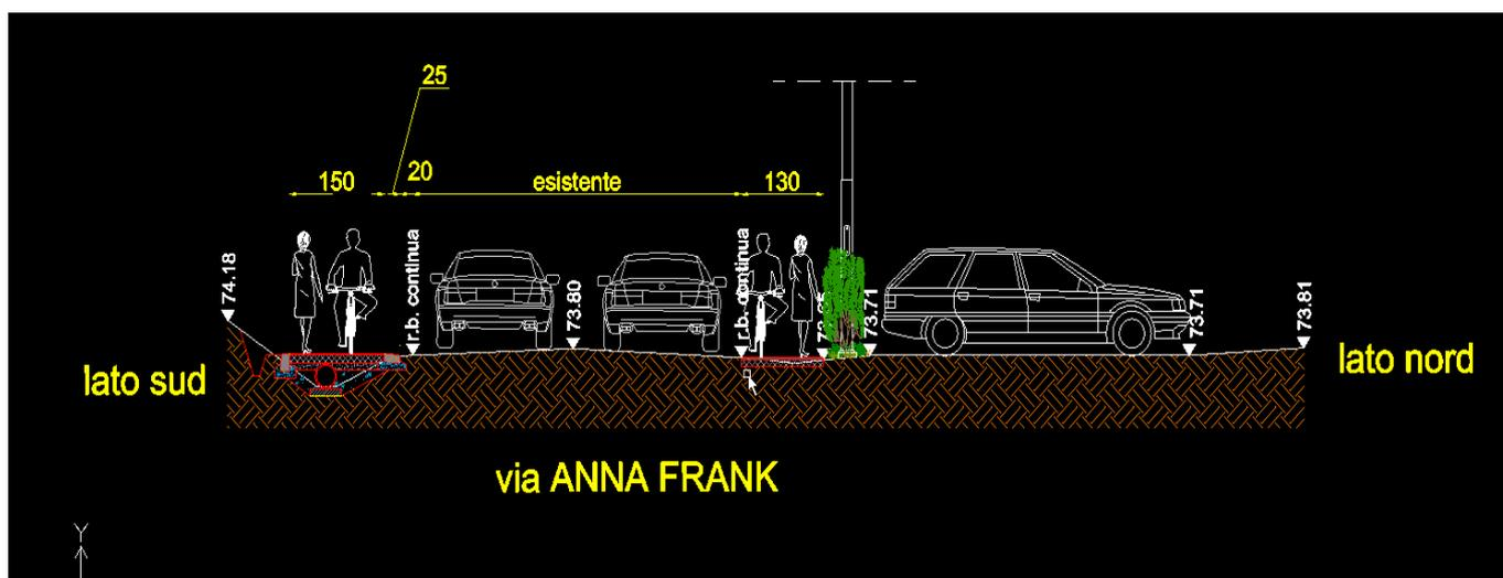
La pavimentazione è prevista mediante tappeto d'usura in conglomerato bituminoso nero dello spessore di cm. 3
