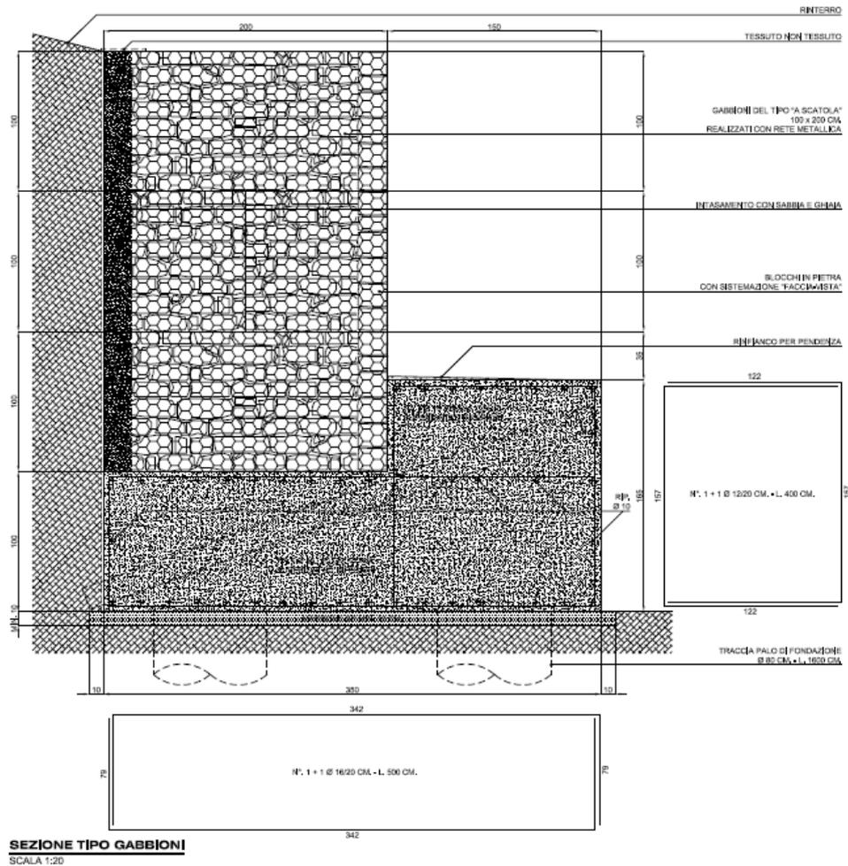
Figura 5 – Sezione tipo della platea di collegamento dei pali su cui viene appoggiata la gabbionata
