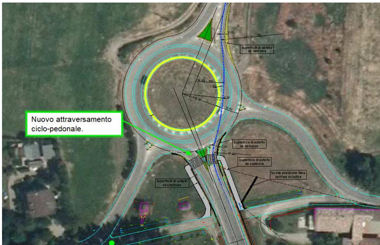
L'intervento consiste nell'utilizzare l'isola spartitraffico esistente, come isola di salvagente, per farsi che i ciclo-pedoni attraversino in due tempi la SP.67 e collegare tale attraversamento ai tratti stradali dismessi in parte di Strada Aiola dalla conseguente realizzazione della Variante Est di Montecchio Emilia dei primi anni 2000.
