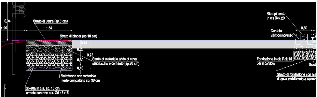
Dalla sezione 23 alla sezione 28 la pista ciclabile sarà realizzata compensando il pedonale con una soletta armata in continuità con l'esistente, doppio cordolo lato Sp.53 e successivo tappeto di binder di 7 cm.
