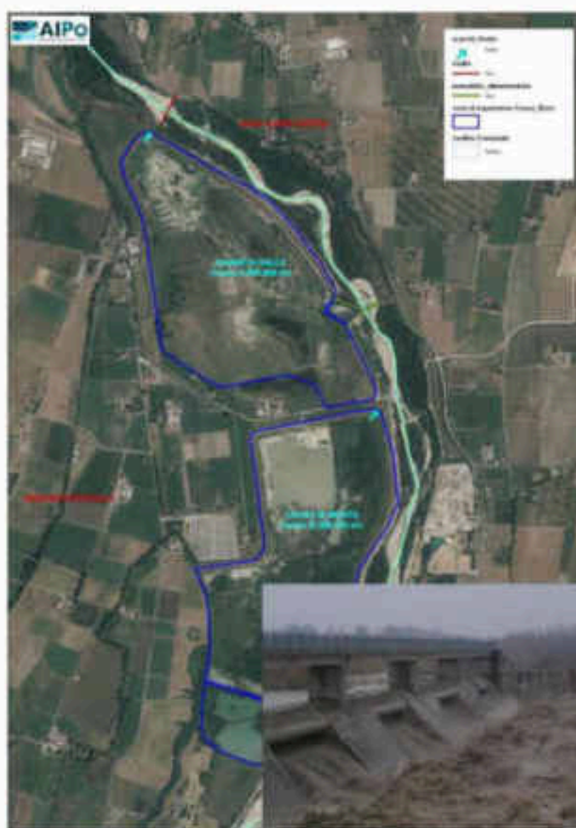
Figura 79 – Casse di espansione in derivazione sul T. Enza presso Montechiarugolo (fonte: AIPo)
