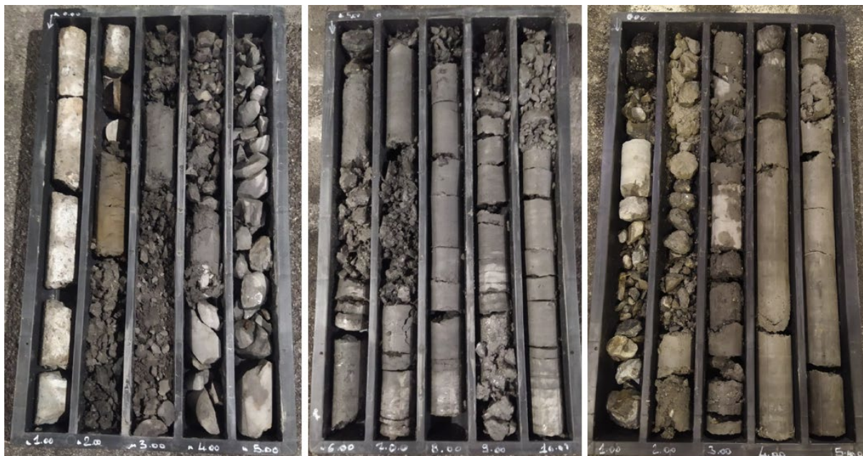
Foto esemplificative dei sondaggi eseguiti: sx) S1 eseguito sul rene di monte, tratto da 0 a 5 m; centro) S2 eseguito sul rene di valle, tratto da 5 a 10 m; dx) S3 eseguito verticalmente sul piano viario, tratto da 0 a 5 m. Si apprezza un'ubiquitaria qualità scadente dell'ammasso roccioso a tergo del rivestimento definitivo.
